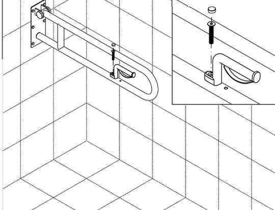
**(FR)** Positionner le porte-rouleau en l'alignant sur le perçage de la barre d'appui rabattable, fixer la vis et enfoncer le cache-vis.
